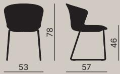
**IT** — Telaio slitta in acciaio
