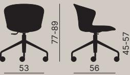
**IT** — Girevole con telaio 4 razze con ruote e gas
