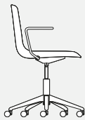
P 1540, U 1541 Base girevole con meccanismo a gas con ruote e braccioli / Swivel base with castors and armrests
