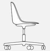
Ⓟ 6530, 6532 Ⓡ 6531 Cinque razze con ruote, girevole, con meccanismo a gas / Swivel aluminium base with castors and gas lift mechanism
